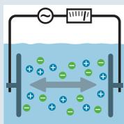
Se aplica una tensión alterna a dos electrodos sumergidos en el producto. El valor de la conductividad se determina de acuerdo con la ley de Ohm.
